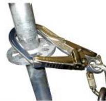
Bild 9 : Anschlagmethode nur für hierfür zugelassene Stahlhaken
